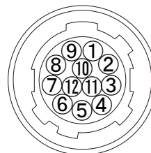
Схема расположения контактов разъема (вид спереди)
